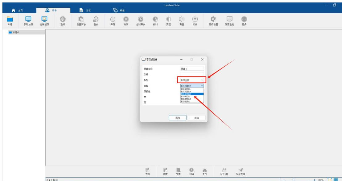
点击“通讯”，并选择对应的通讯方式（LCD 控制卡目前支持以太网、WiFi AP、WiFi STA 三种通讯方式），或选择“网络配置”对通讯方式进行配置，完成网络配置及通讯方式选择后点击“确定”；
